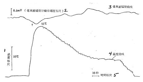
用双笔 X-Y 记录仪同步记录的温升过程及毫米波辐射特性
