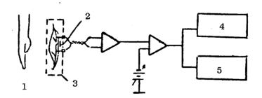
国4:一种生物探测曲器通行意图,其中,受消人; 山宁样;3.容品;4.示波器;5.记录仪
