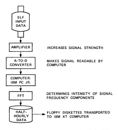
FIGURE 1 (U) ELF DATA-ACQUISITION SYSTEM
