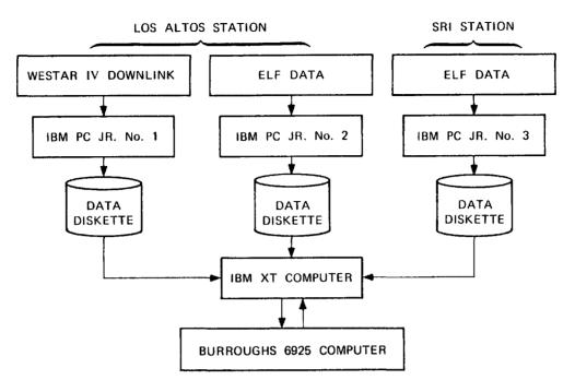
FIGURE 3 (U) REAL-TIME GEOPHYSICAL DATA-ACQUISITION SYSTEM
