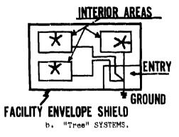
FIGURE 26. GROUNDING CONFIGURATIONS.
